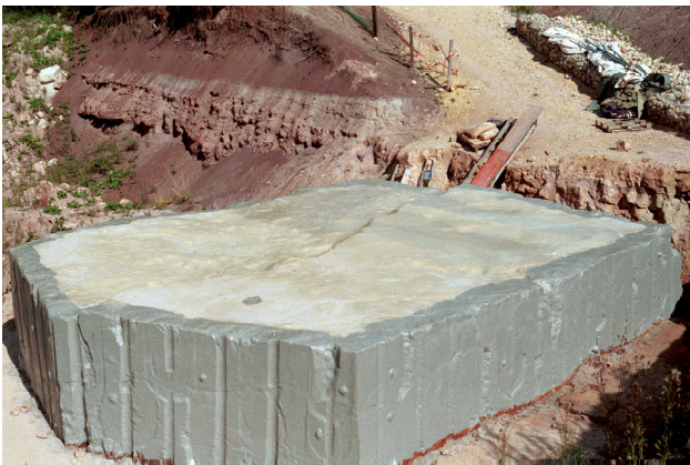
Abb. 3-12: Vollständig eingeharzte Seitenwände des Feldversuchsblocks (Südost-Ansicht).
