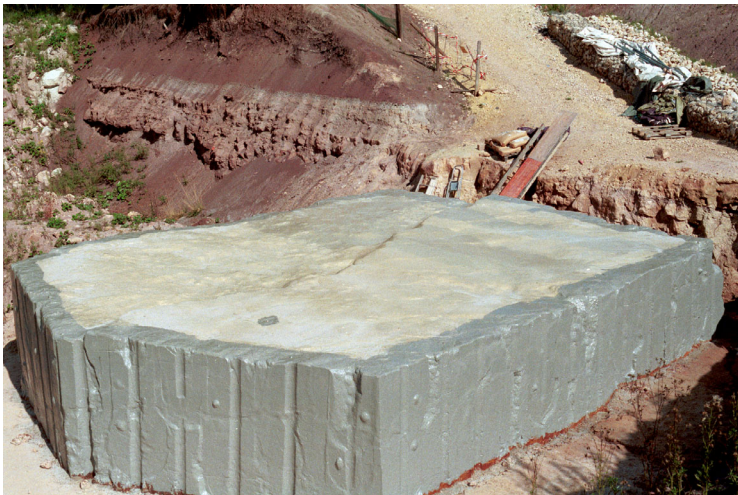
A-3.5: Kapselung des Feldversuchsblocks: vollständig gekapselter Versuchsblock
