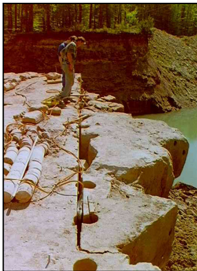
A-2.4: Aufweiten eines Sägeschnittes mit Hydrodruckkissen
