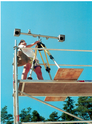
Abb. 4-1: Stereophotogrammetrische Aufnahme der Kluffsignaturen auf der Feldversuchsblock-Oberfläche
