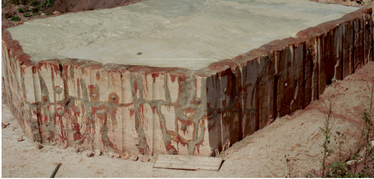
A-3.4: Kapselung des Feldversuchsblocks: eingeharzte Klüfte auf den Wänden
