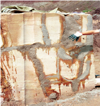
Abb. 3-10: Mit Trasszement verschlossene Kluftausbisse an der SE-Wand des Feldversuchsblocks
