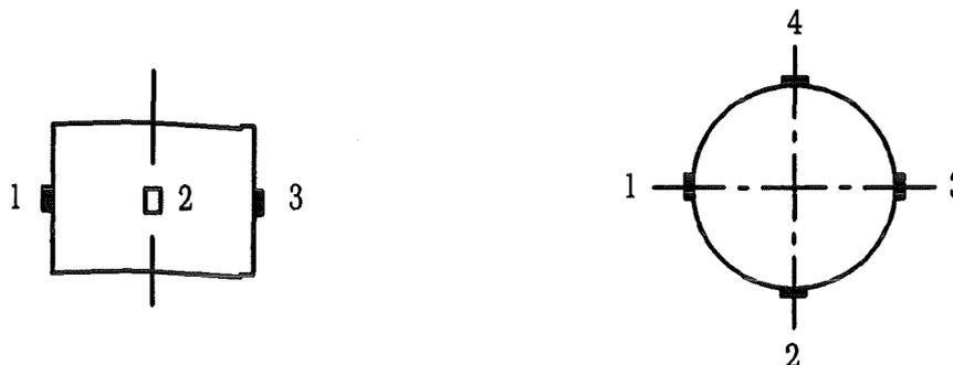
Abbildung 104: Anordnung der DMS auf Keramik - Metall - Verbundproben.
