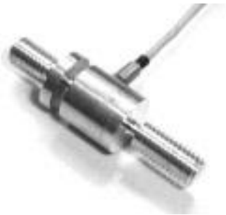
Abbildung 4: Kraftsensor zur Momentenmessung im Ellenbogen.
