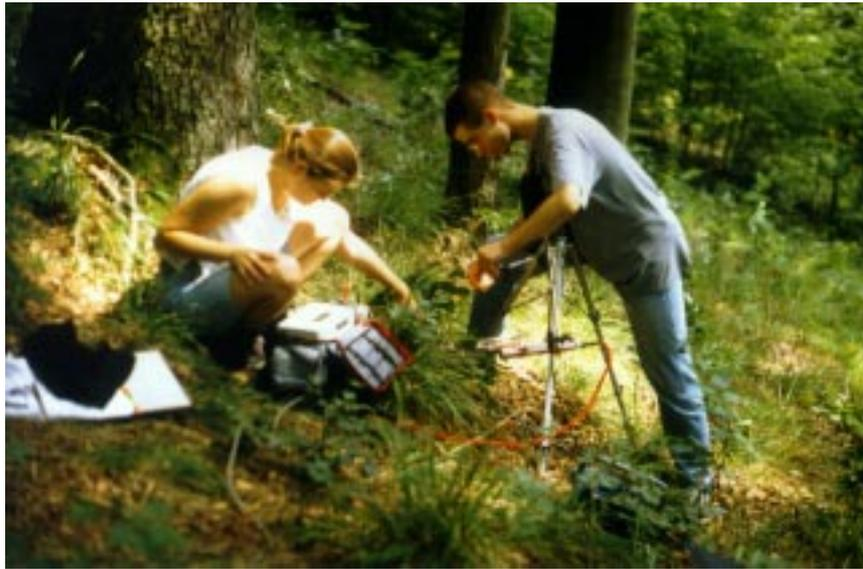
**Abb. 2.16:** S. Bilke und T. Längle bei Photosynthesemessungen mit dem tragbaren CO<sub>2</sub>/H<sub>2</sub>O-Porometer.
