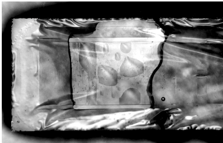
Abb. 12-9: Durch Säureeinwirkung zerstörter parylenbeschichteter Sensor. Zu erkennen ist der durch eine Gasblase angehobene Parylenfilm.
