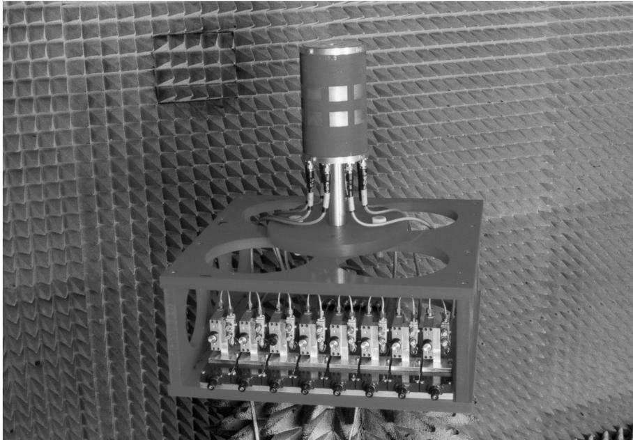
**Bild 8.3** Aufbau zur Messung der Richtcharakteristiken des Phased-Arrays nach Bild 1.4, zu erkennen ist ein 8-kanaliges Netzwerk mit mechanischen Phasenschiebern und jeweils darüber montierten einstellbaren Dämpfungsgliedern
