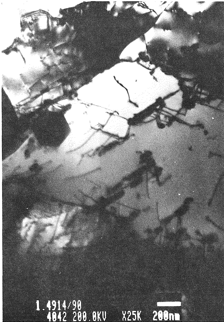
Abb. 7.64 a,b: TEM-Aufnahme von Mikrostruktur einer Zeitstandprobe in Luft, \sigma = 180 \text{ MPa} , t_B = 2066 \text{ h} ; X 18 CrMoVNb 12 1 (MANET-1)
