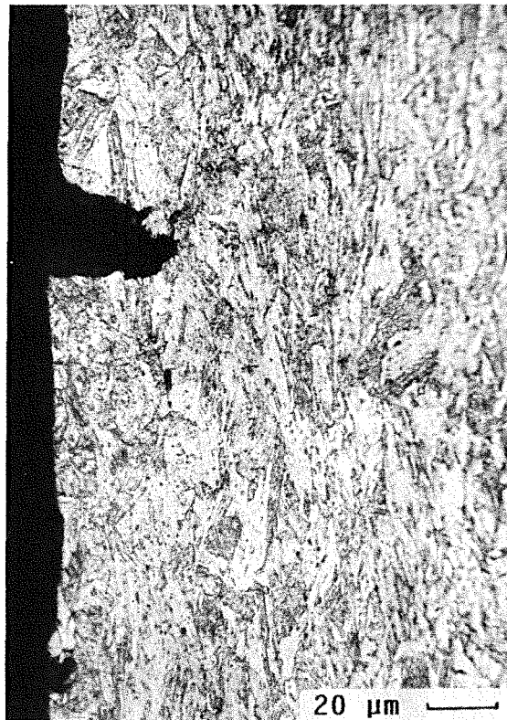
Abb. 7.8 a-b: REM und Schliffbild einer Probe, die in Pb-17Li geprüft wurde; X 18 CrMoVNb 12 1 (MANET-1); a) Bruchbereich; b) vergrößerte Anrißbildung; Vergr. 500-fach
