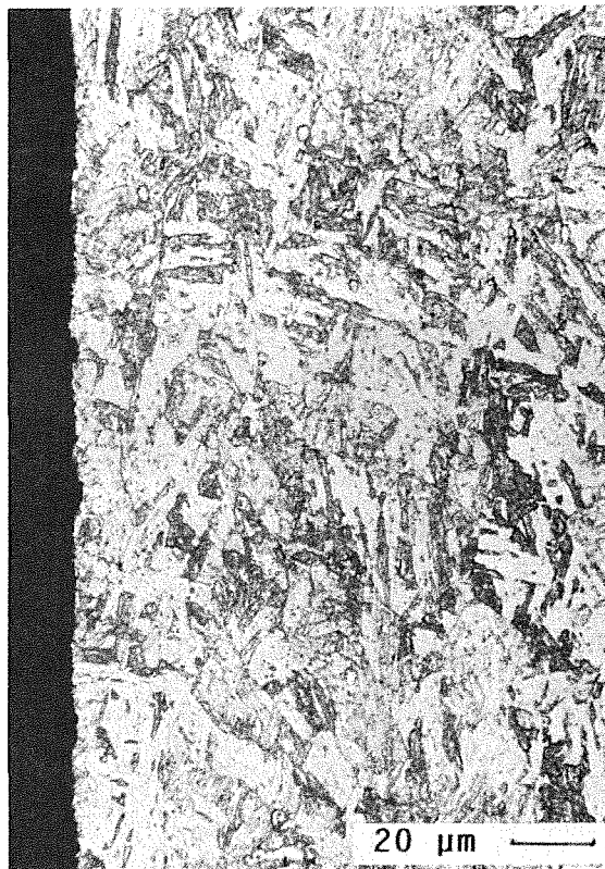
Abb. 7.56a,b: Metallographische Schlitte von Gefüge und Randzone ausgelaugter Proben a) 1000 h, \sigma = 220 MPa, t_B = 44 h b) 1000 h, \sigma = 220 MPa, t_B = 48 h X 18 CrMoVNb 12 1 (MANET-1)
