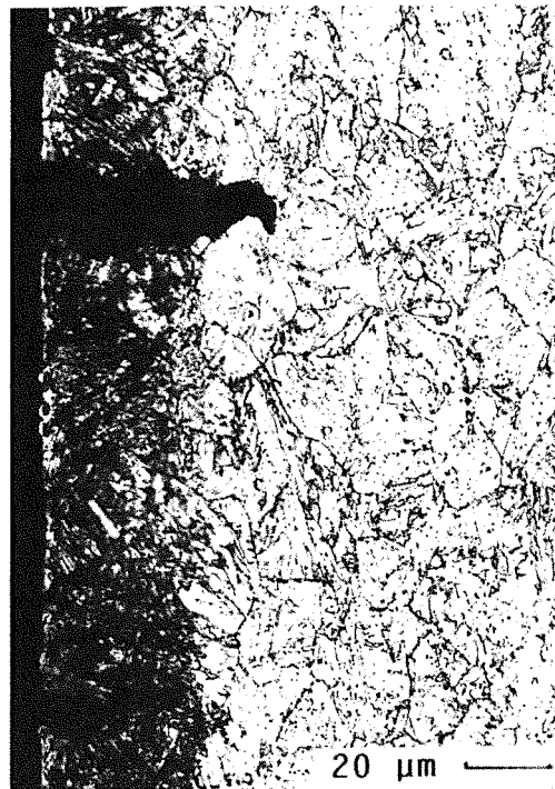
Abb. 7.13 a, b: Metallographie der in Li zerrissenen Probe; X 18 CrMoVNb 12 1 (MANET-1); a) verformungsloser Teller-Tasse-Bruch; Vergr. 15-fach b) starke Anrißbildung; Vergr. 500-fach
