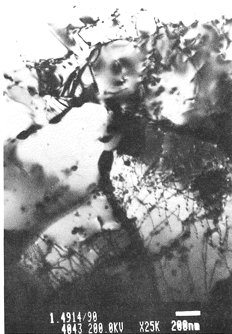
Abb. 7.64 a,b: TEM-Aufnahme von Mikrostruktur einer Zeitstandprobe in Luft, \sigma = 180 \text{ MPa} , t_B = 2066 \text{ h} ; X 18 CrMoVNb 12 1 (MANET-1)
