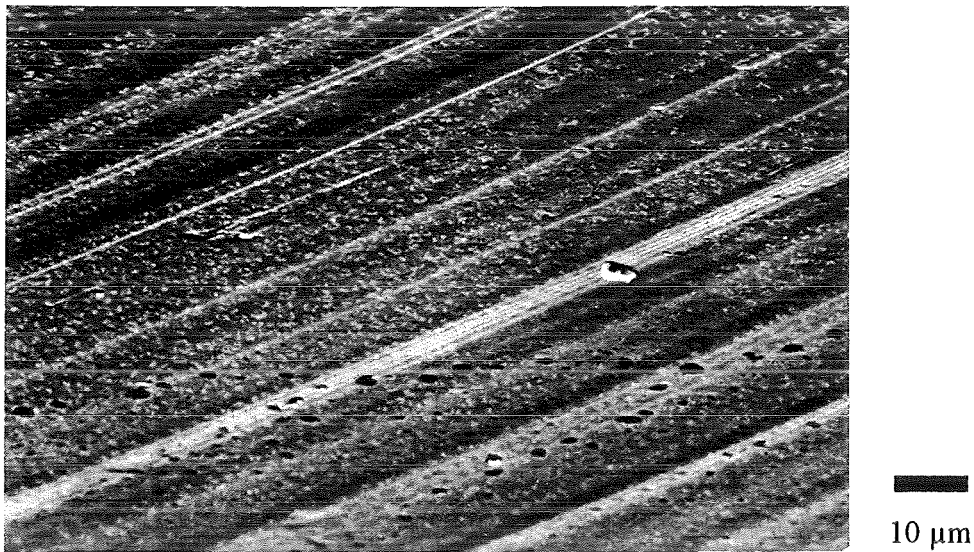
Abb. 104: REM-Aufnahme der Reibbahn einer TiN-B 4 C-TiC-Viellagenschicht (B 4 C 2 nm) nach Pin-on-Disk-Versuch gegen 100Cr6 (Substrate Hartmetall, Schichtdicken 5 µm)
