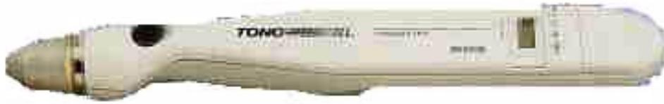
**ABBILDUNG 4.6: HANDTONOMETER TONO-PEN NACH DEM PRINZIP VON MACKAY/MARG**
