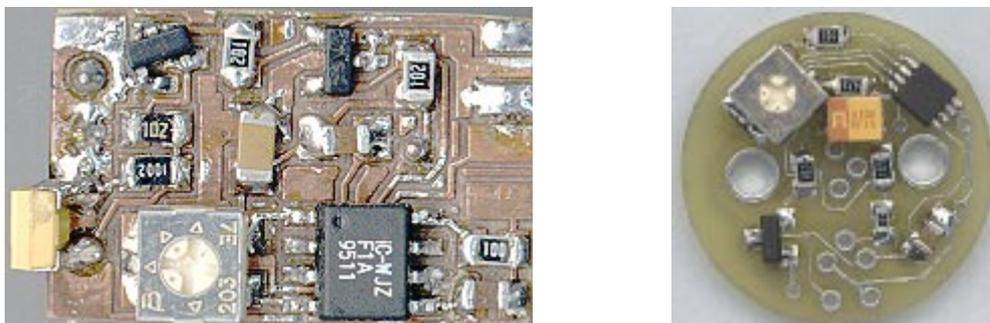
**ABBILDUNG 9.34: LASERMODUL MIT REGELELEKTRONIK; TEMPERATURREGELUNG**
