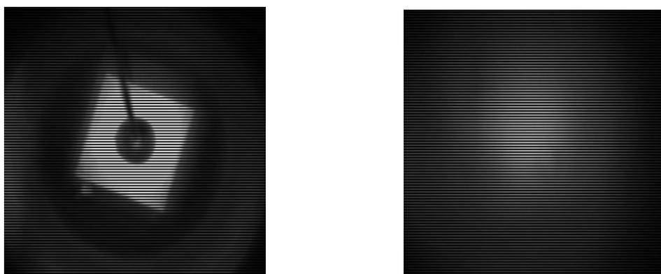
**ABBILDUNG 9.48: MONITORBILD ZUR JUSTAGE DER Z-ACHSE (LINKS: JUSTIERT, RECHTS: DEJUSTAGE IN Z)**
