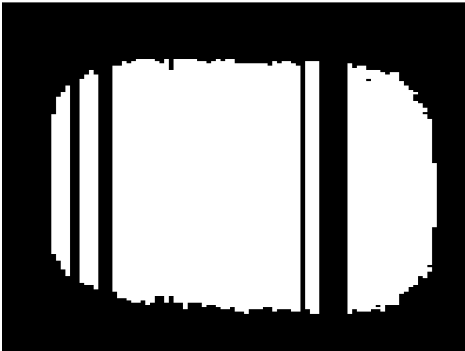
Abbildung 6.3: Kontur der Bodenaufstandsfläche von Reifen 1
