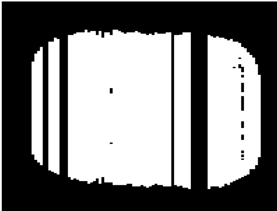
Abbildung 6.4: Kontur der Bodenaufstandsfläche von Reifen 2
