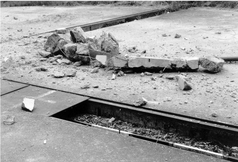
**Bild 3.18b:** Fragmente von VK 4 nach dem Versuch; die größten Stücke werden von der Bewehrung zusammengehalten, kleinere Teile sind in der Umgebung verteilt.
