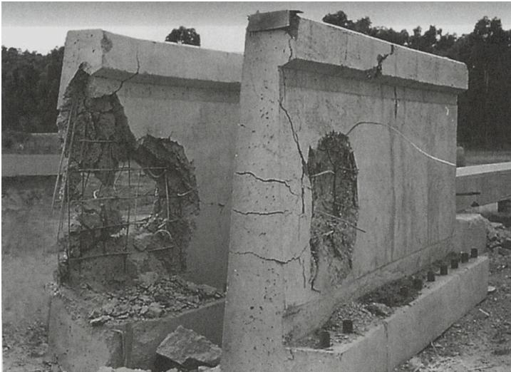
**Bild 1.4:** a) ZeuS Simulation eines 'backward-fold' EFP's und b) Perforation von zwei Stahlbetonwänden, aus *Weickert* [1998]
