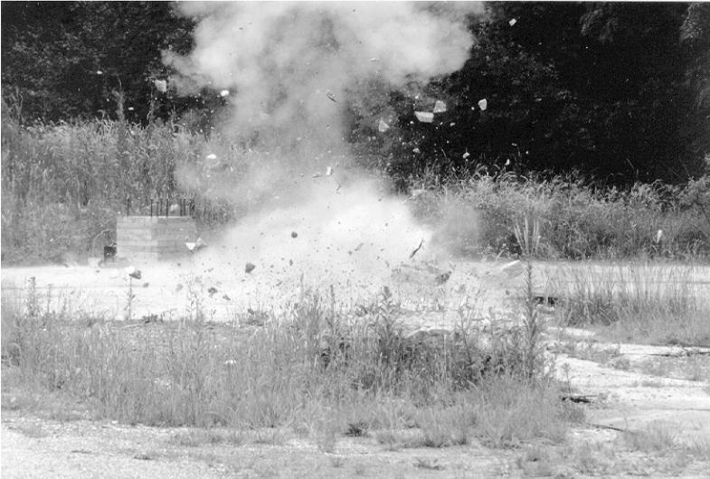
**Bild 3.18a:** Totale Fragmentierung von VK 4 während des Versuchs; die Trümmer verteilen sich in einem Radius von etwa 12 m.
