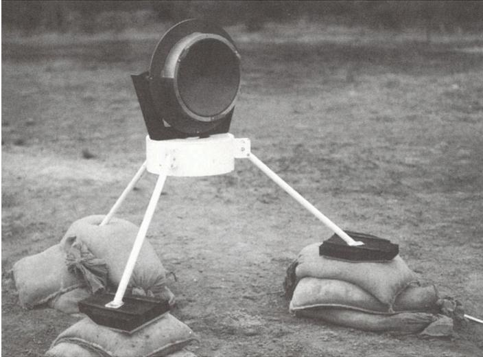
**Bild 1.3:** EFP-Einheit mit einem EFP-Durchmesser von 300 mm aus *Weickert* [1998]
