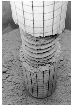
**Bild 3.24:** Stütze nach dem Versuch
