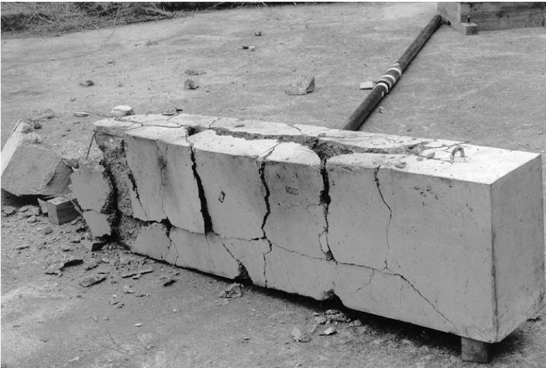
**Bild 3.17:** VK 3 nach dem Versuch; ein Trennriß geht annähernd durch die gesamte Bohrlochebene. Auf der Höhe der Ladungen (in 35 cm Tiefe, von oben gemessen) ist außerdem ein weiterer globaler Trennriß in horizontaler Richtung zu erkennen.
