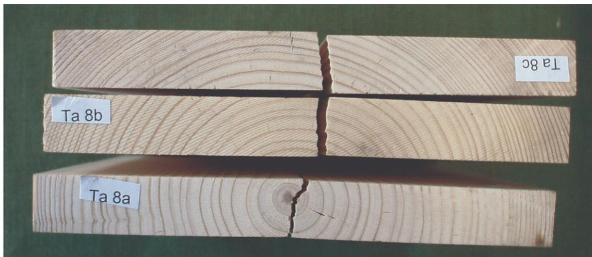
**Bild 5.2.6:** Ansicht der Schmalseite von Tannenprüfkörpern nach dem Versuch
