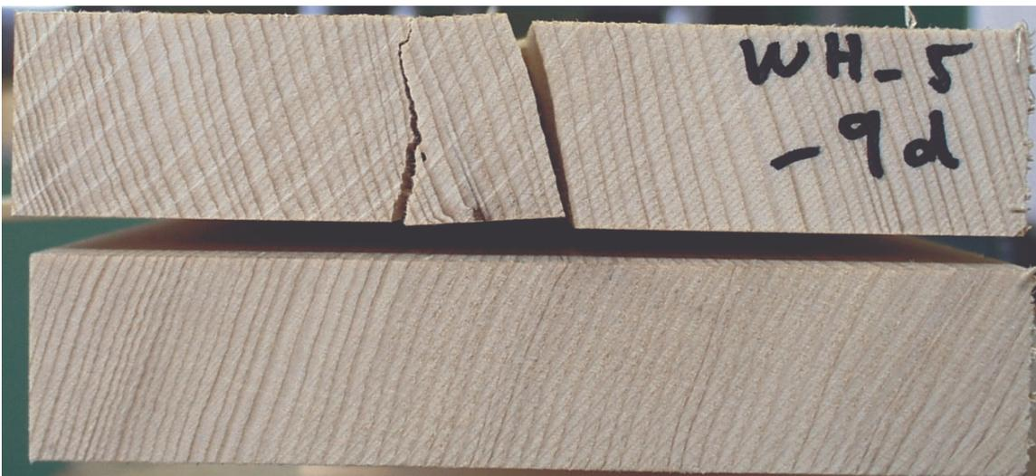
**Bild 6.2.15:** Typische Anordnung der Jahrringe bei Prüfkörpern der Holzart western hemlock
