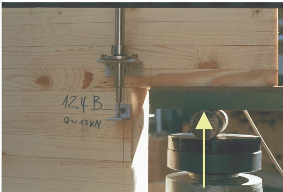
**Bild 2.2.4:** Ausklinkung mit Riss an einem Brettschichtholzträger
