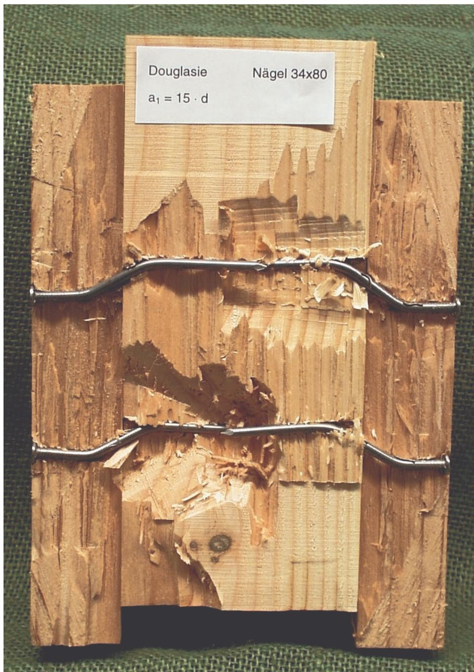
**Bild 8.2.11:** Geöffneter Anschlussbereich eines Prüfkörpers aus Douglasienholz
