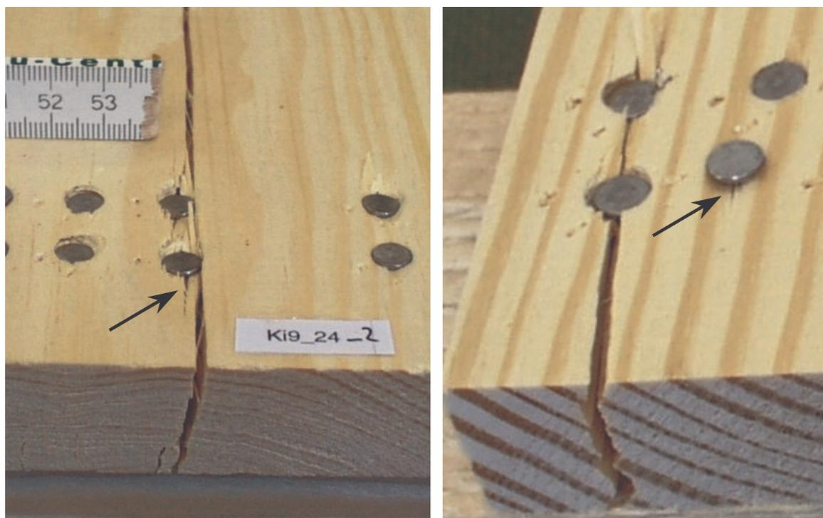
**Bild 7.1.1:** Risse bei Einschlagversuchen
