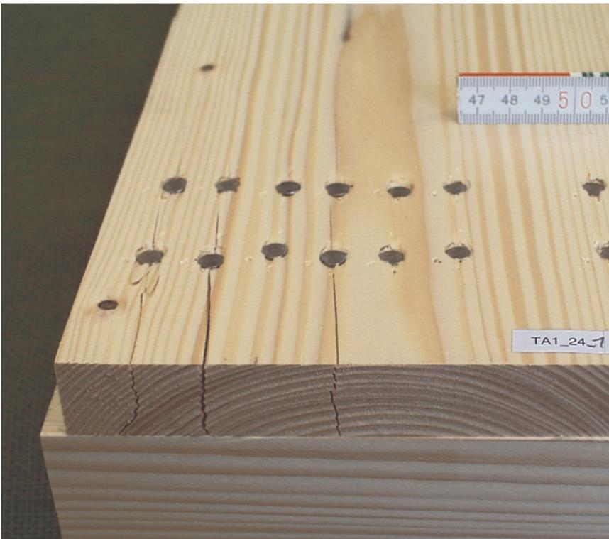
**Bild 2.3.5:** Spalten durch Einschlagen von Drahtstiften
