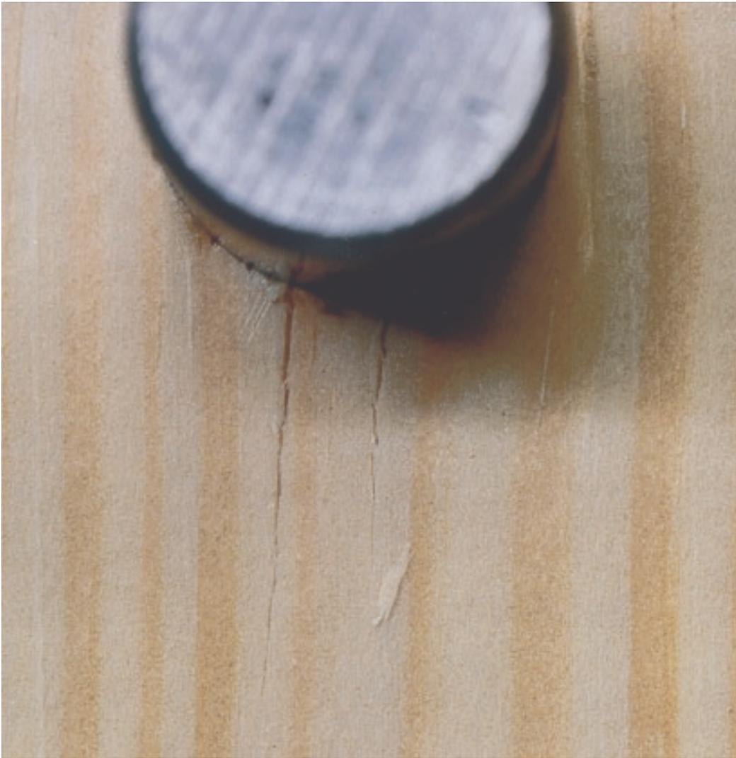
**Bild 2.3.3:** Zwei Risse an einem Prüfkörper nach Abschnitt 6
