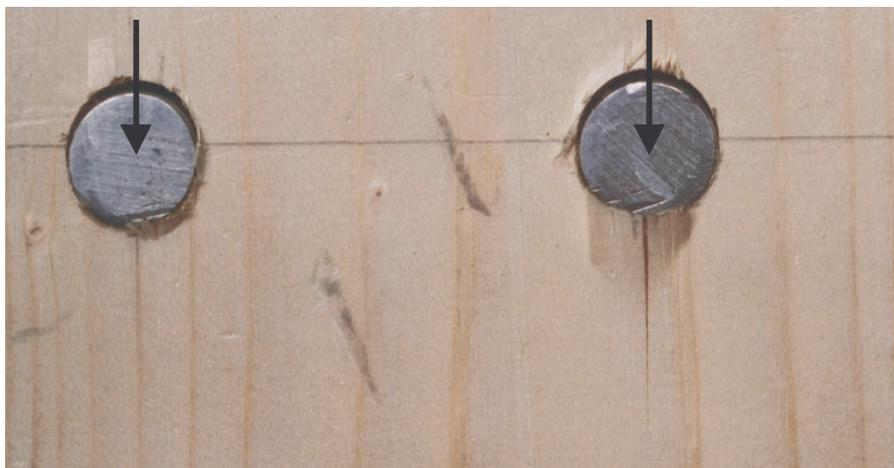
**Bild 2.3.1:** Stabdübelgruppe, der rechte Dübel mit sichtbarem Anriss
