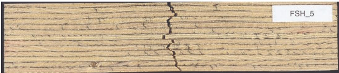
**Bild 5.3.15:** Verlauf der Rissfront in einem Prüfkörper aus FSH
