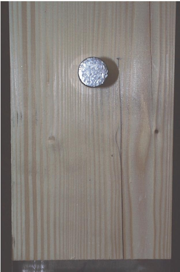
**Bild 6.2.2:** Schwindriss bei Prüfkörper Ta\_10\_9d
