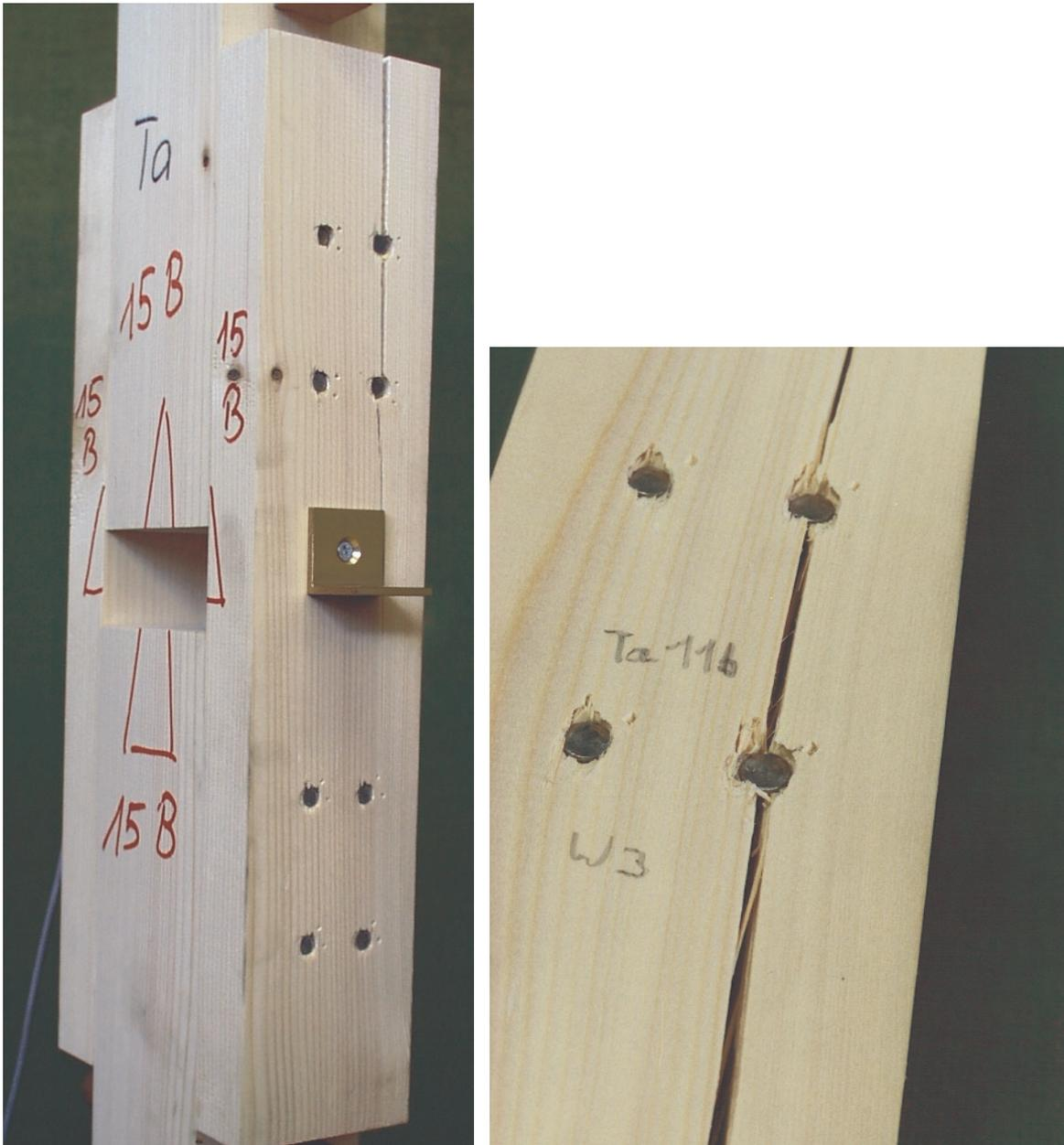
**Bild 8.2.3:** Gespaltene Zugscherversuche aus Tannenholz
