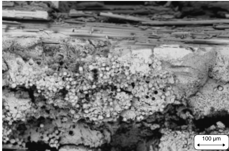
Abb. 5.3.2-2: Bruchfläche einer 150 h oxidierten Probe bei 1200 °C nach einem Kurzbiegeversuch
