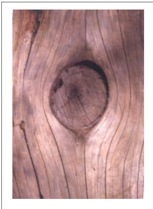
Abbildung 3.7: Spindelförmiger Faserverlauf um einen morschen Ast.
