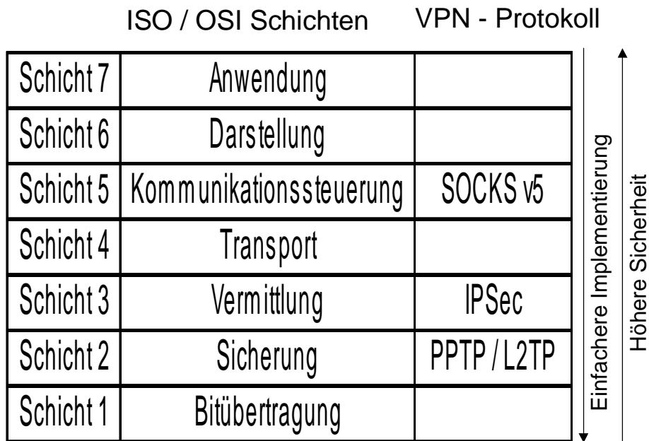
Abbildung 5: Einordnung der VPN-Protokolle im ISO/OSI-Basisreferenzmodell
