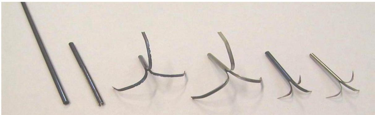
*Abb. 7.10: Fertigungsablauf eines NiTi-Ankers aus Rohrmaterial*
