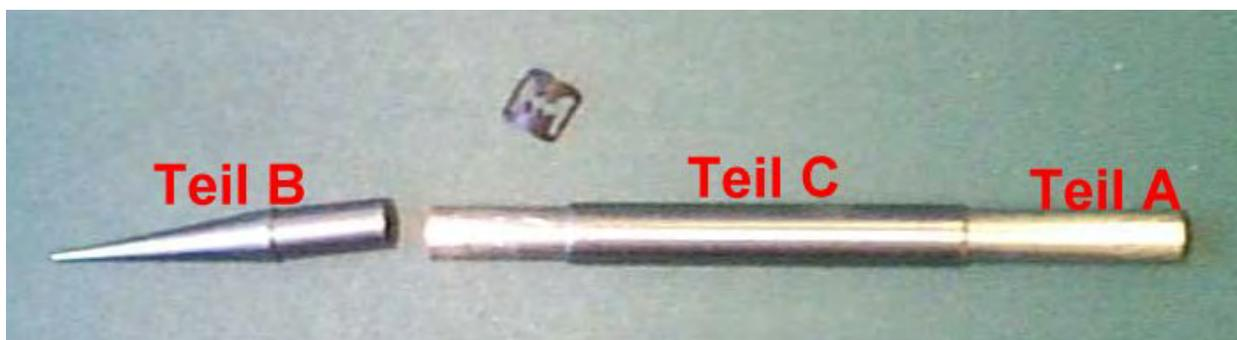
Abb. 4.19: Testspitze zum Laden und Applizieren der Klammer
