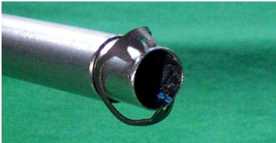
Abb. 4.9: Klammervariante B im aufgespannten Zustand
