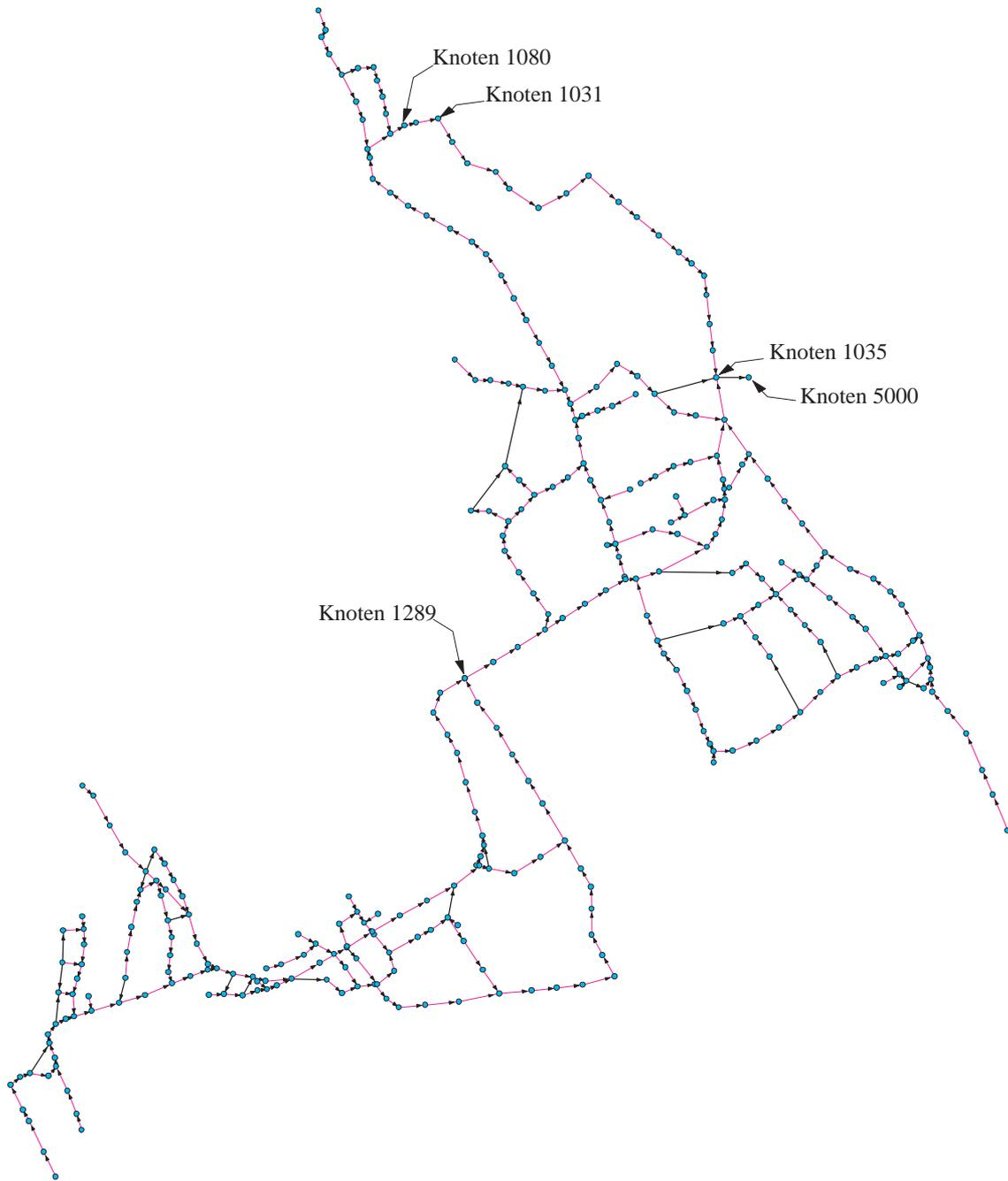
Abbildung 4.8: Systemgraph zur Kanalnetzoptimierung
