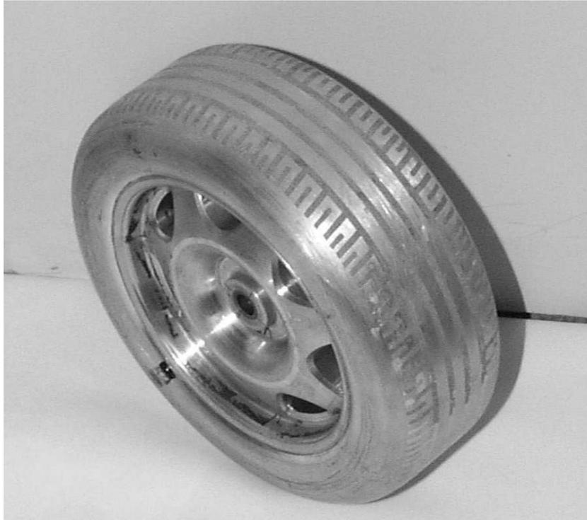
Abb. 5.47: Rad des M1:4-Modells mit aufgefülltem Reifenprofil
