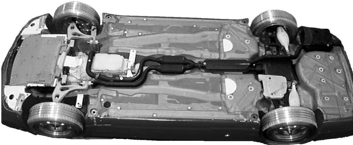
**Abb. 2.21:** Detaillierter Unterboden des M1:4-Modells
