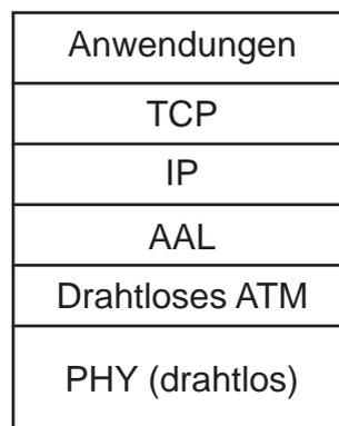
Abbildung 3: *TCP/IP over ATM* Protokollturm für drahtloses ATM
