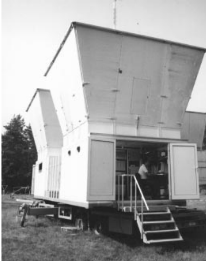
Abbildung 1: Das Wind-Temperatur-RADAR auf dem Gelände des Forschungszentrums Karlsruhe. Hinten die Sende- und vorne die Empfangsantenne, rechts auf einem Ausleger (verdeckt) die Schallquelle. Die Trichter sind von innen mit Absorbiermaterial ausgekleidet und sollen die horizontale Abstrahlung verringern. Unter der Sendeantenne ist Platz für die wassergekühlten Halbleiter-Sendeverstärker und deren Netzteile, und unter der Empfangsantenne sind die elektronischen Komponenten des Empfängers und einige Rechner.
