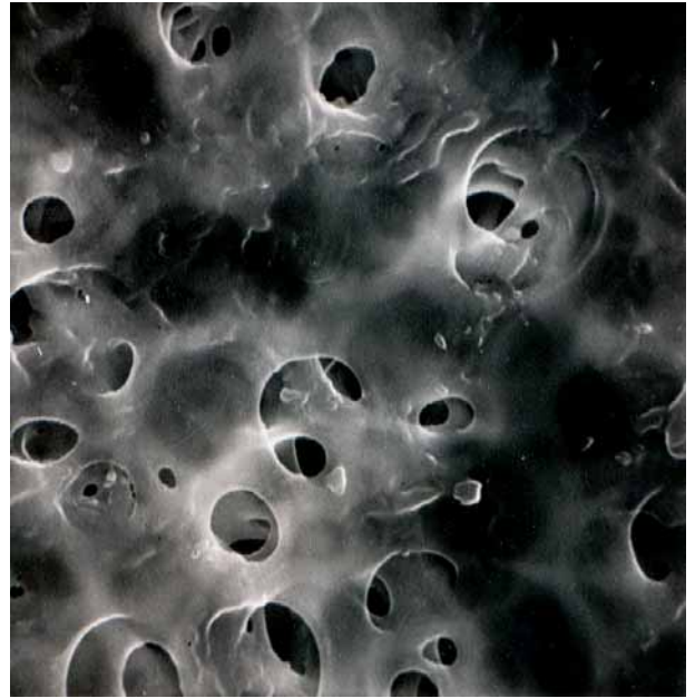
Abb. A-5: 0.45 µm-Membran (1:10000 vergr.) Feed Moorwasser; Aufnahme nach NaOH-Reinigung
