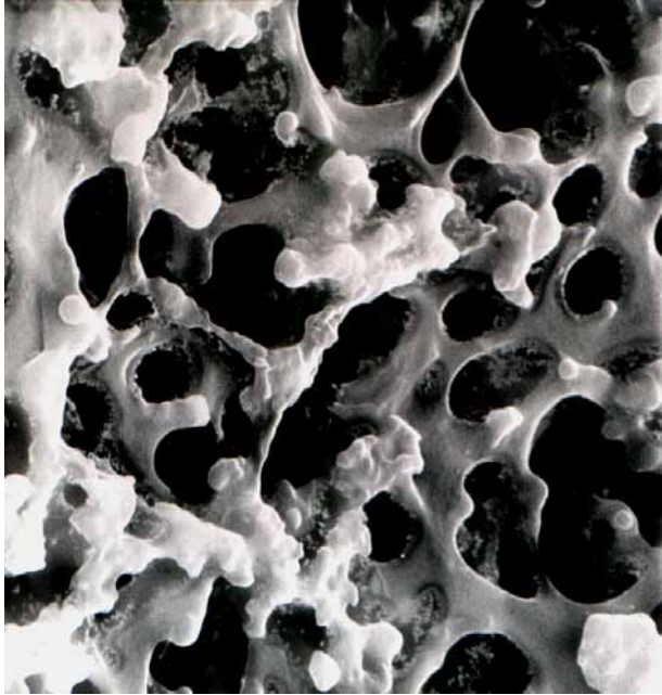
Abb. A-8: 0.8 µm-Membran (1:5000 vergr.) Feed Klärwerk-Gesamtablauf; Aufnahme nach H 2 O 2 -Reinigung
